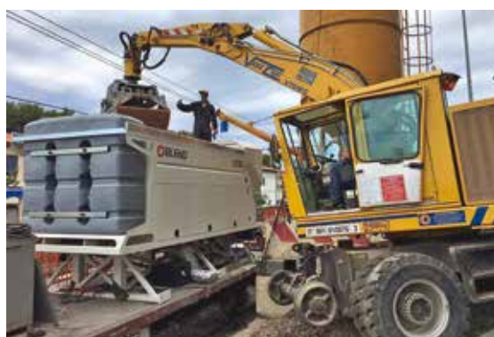
4. Il carico degli inerti avviene in modo rapido sia con i caricatori ferroviari, sia tramite altri sistemi a nastro o a tramoggia dimostrando ampio adattamento a qualsiasi situazione operativa
