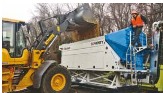
6. Il carico degli inerti può avvenire senza problemi anche con una pala gommata di dimensioni adeguate alla dimensione delle tramogge evidenziando ulteriore flessibilità operativa
