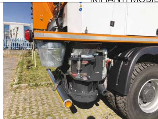
2A e 2B. Easyfloor è disponibile in due versioni: la P70 con pompa a pistoni (2A) e la A70 con pompa ad aria (2B) per far fronte a diverse esigenze produttive e di pompaggio
