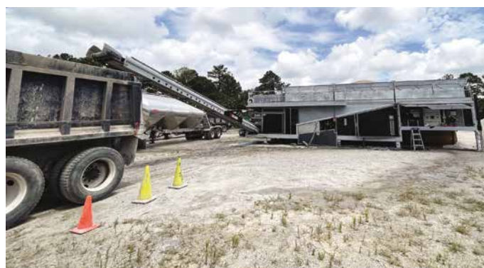
3. Il Blend A240 è l'impianto pensato per grandi produzioni per soddisfare la richiesta di una mobilità molto elevata e flessibilità di utilizzo. Può produrre calcestruzzo, anche da materiale riciclato, misti cementati, asfalto a freddo ed RCC (Calcestruzzo Rullo Compattato)
