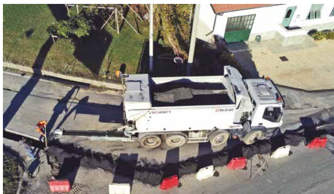
6. L'impianto Seventy può confezionare calcestruzzo da materiale di scarto da demolizione e asfalto a freddo con 100% di bitume d'asfalto riciclato
