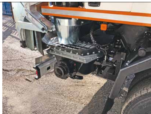
2A e 2B. Easyfloor è disponibile in due versioni: la P70 con pompa a pistoni (2A) e la A70 con pompa ad aria (2B) per far fronte a diverse esigenze produttive e di pompaggio
