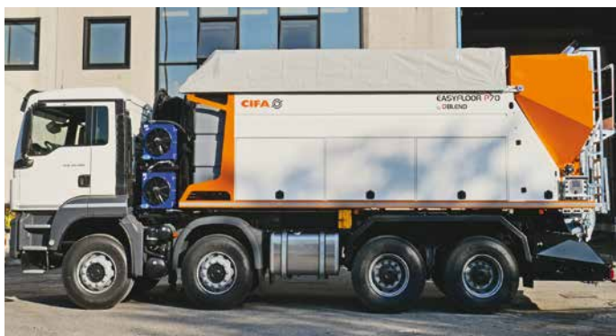
1. Easyfloor P70 allestita su autotelaio a quattro assi 1. Easyfloor P70 fitted on a 4-axis chassis
